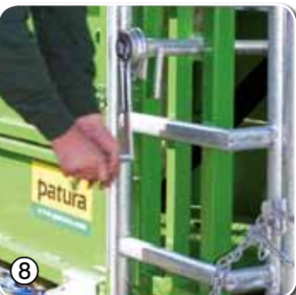
8 Rückschlagfreie Hinterfußwinde zum leichten Anheben der Hinterfüße
