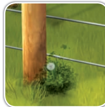
leichter Bewuchs – ab und zu berührt Bewuchs den Zaundraht
