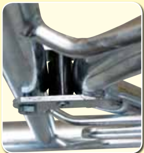
Innenliegender Kunststoffpuffer zur Rückstellung des Fangbügels
