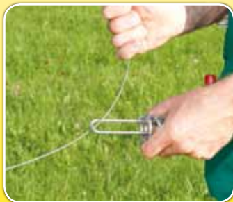
Draht in einen Bügel der Feder einführen
