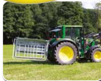
Transport über Schlepper-Dreipunkt-Anhängung mit beigeklapptem Kälberschlupf
