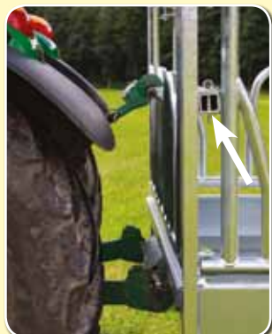
Stabile Konstruktion für leichtes Anhängen über Ackerschleppschere und massive Oberlenkeranhangung aus 8 mm Vierkantring
