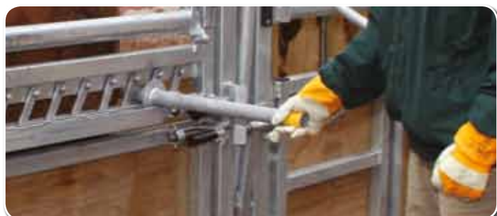
Sicher zu verschiebende Rückwärtssperre (Beckenstange) mit Rückstoßblockierung
