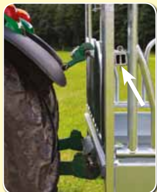
Stabile Konstruktion für leichtes Anhängen über Ackerschiene und massive Oberlenkeranhangung aus 8 mm Vierkantrrohr
