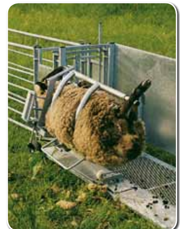
Von beiden Seiten optimaler Zugang zum Tier durch Ausschwenkvorrichtung
