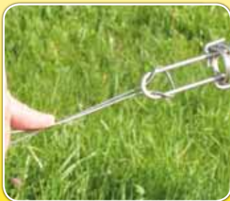
Die Hälfte des Weberknotens ausführen
