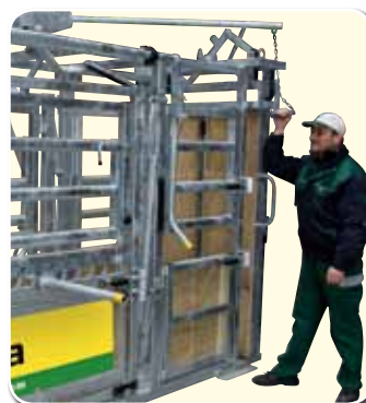
Öffnen der rechten Auslasstür per Hebel von der gegenüberliegenden Seite
