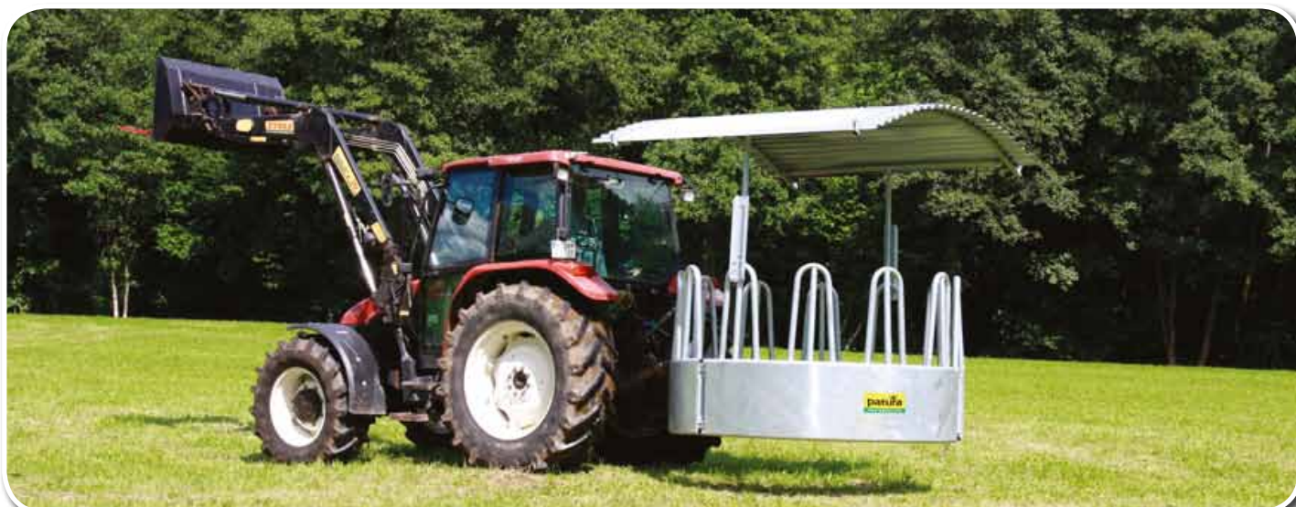
Transport der Rundballenraufe mit Dach und Palisaden-Fressgittern an der Schlepperdreipunkthanhängung
