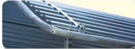
303545: Umlaufender Dachkanten-Schutzbügel zum Abdecken der Dachblechecken (Zusatzrüstung)
