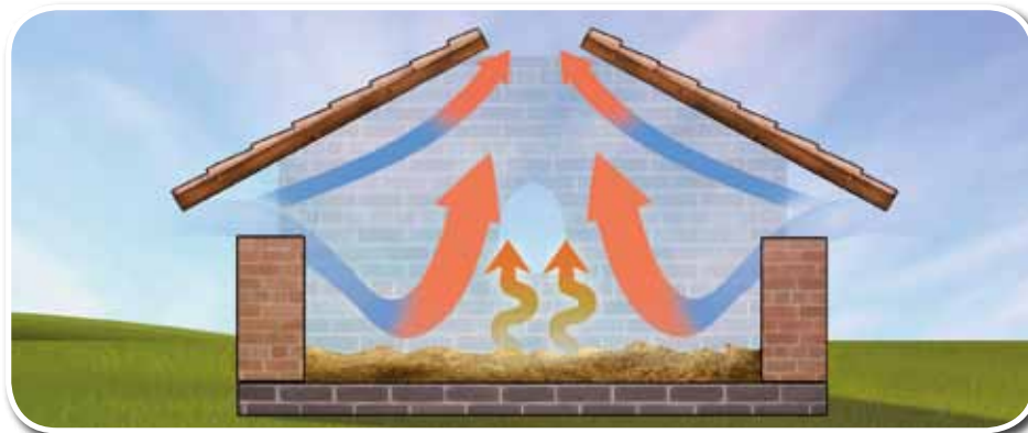
Natürliche Stalllüftung nach dem Schwerkraftprinzip
