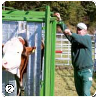
② Über eine Kurbel lässt sich die Halsweite jederzeit verstellen
