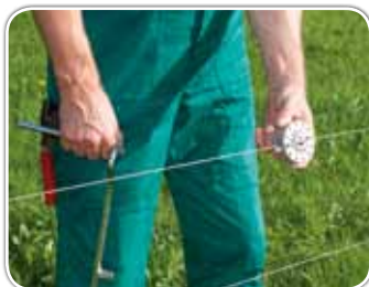
Spanner in den Draht einlegen, Spannbügel einsetzen
