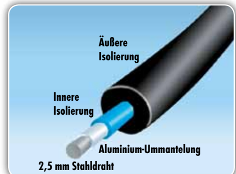
Das PATURA Hochspannungs-Elektrozaunkabel mit Aluminium-Ummantelung sorgt durch hohen Aluminiumanteil für optimale Leitfähigkeit.
