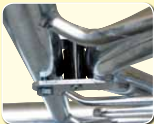
Innenliegender Kunststoffpuffer zur Rückstellung des Fangbügels
