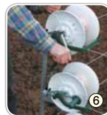
6 ... durch Rückwärtsdrehen der Haspeln spannen
