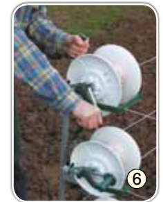
... durch Rückwärtsdrehen der Haspeln spannen
