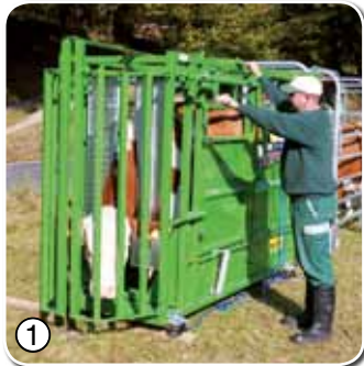
① Fangkorb und zentrale Einhand- Bedienung für sicheres Fangen
