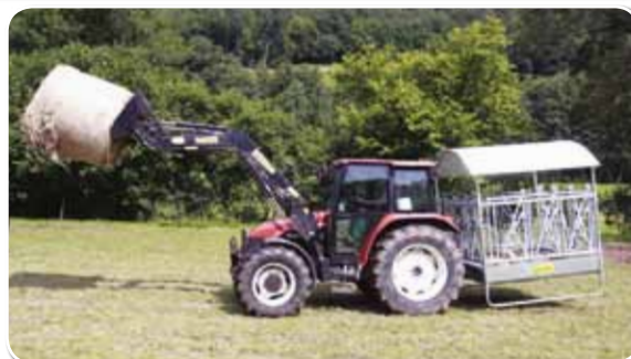
Transport über Schlepperdreipunkt, ungefüllt mit max. 10 km/h
