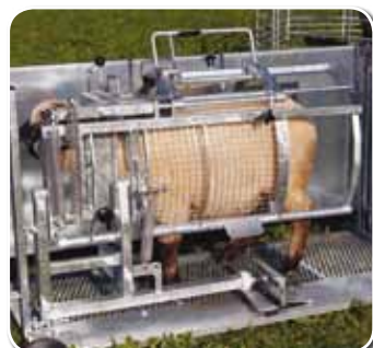
Höhenverstellbarer Wendekorb zum Anpassen an die Tiergröße
