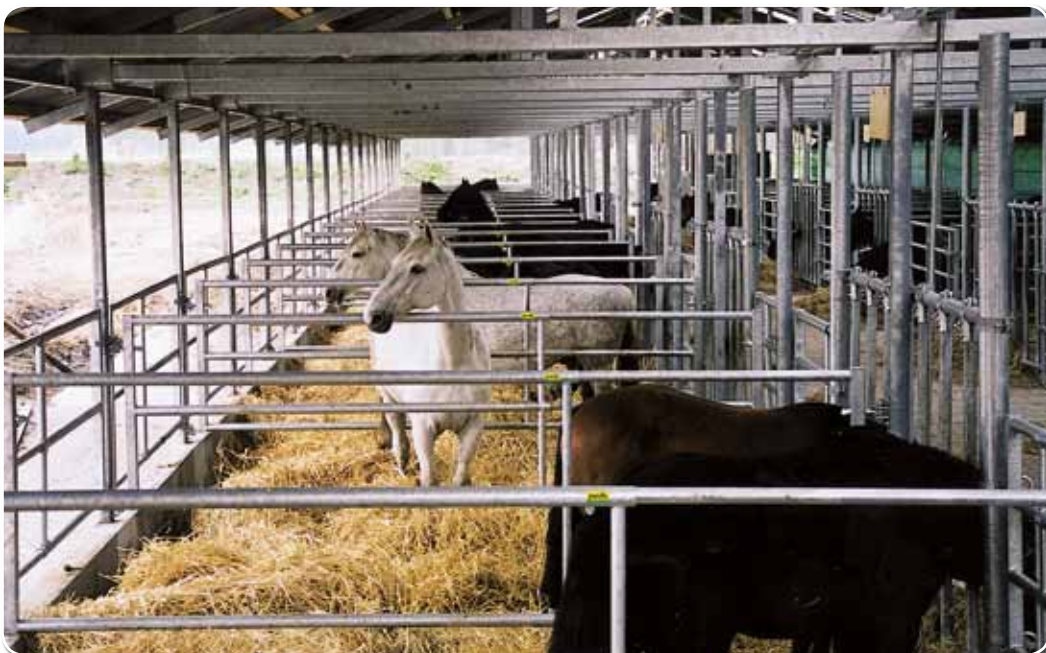
Offene, niedrige Trennwände für leichten Sozialkontakt der Tiere untereinander. Großzügige Boxenabmessungen (3 x 4 m) für optimale Bewegungsfreiheit.
